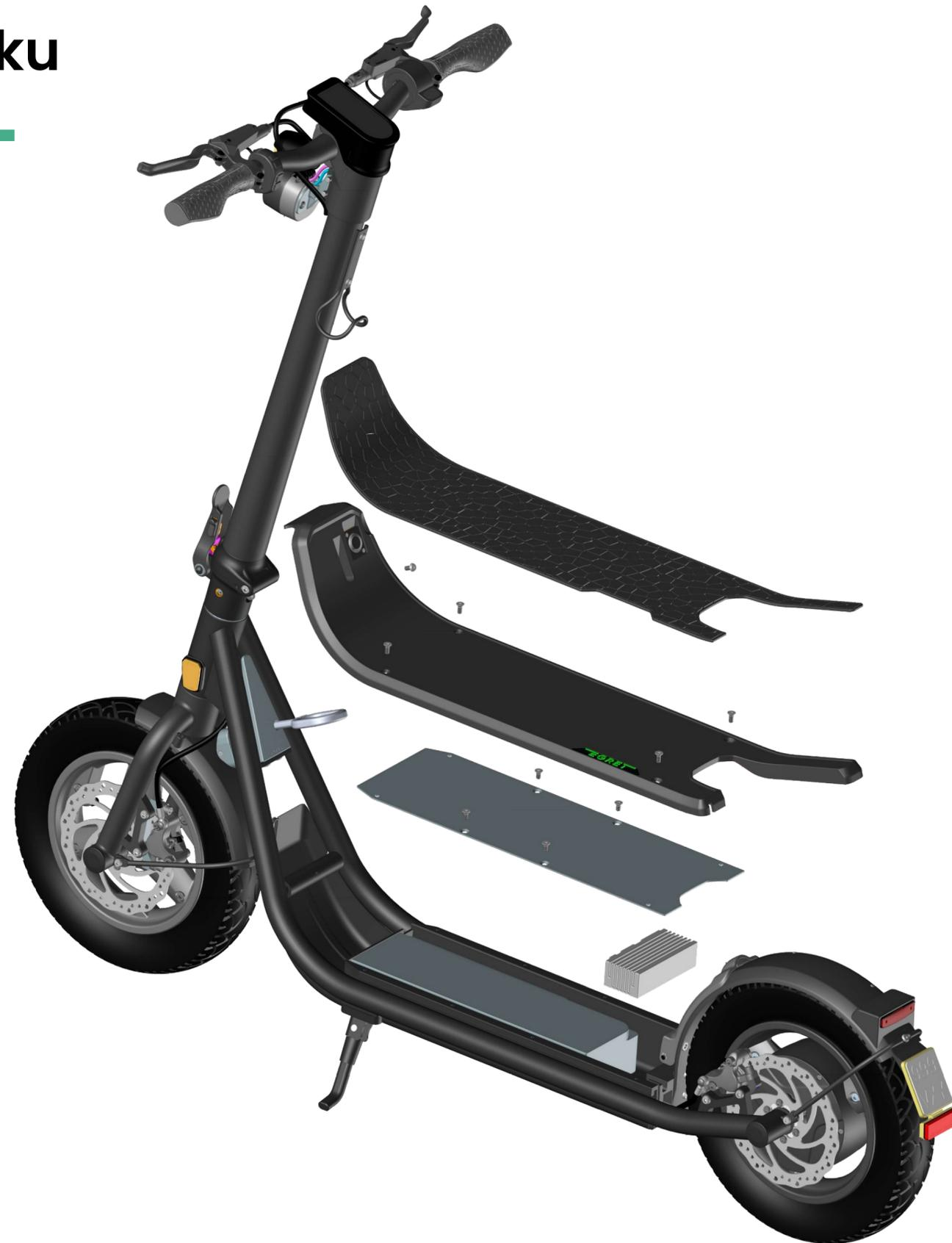
1. Demontiere das Trittbrett und löse die Steckverbindung der Ladebuchse
