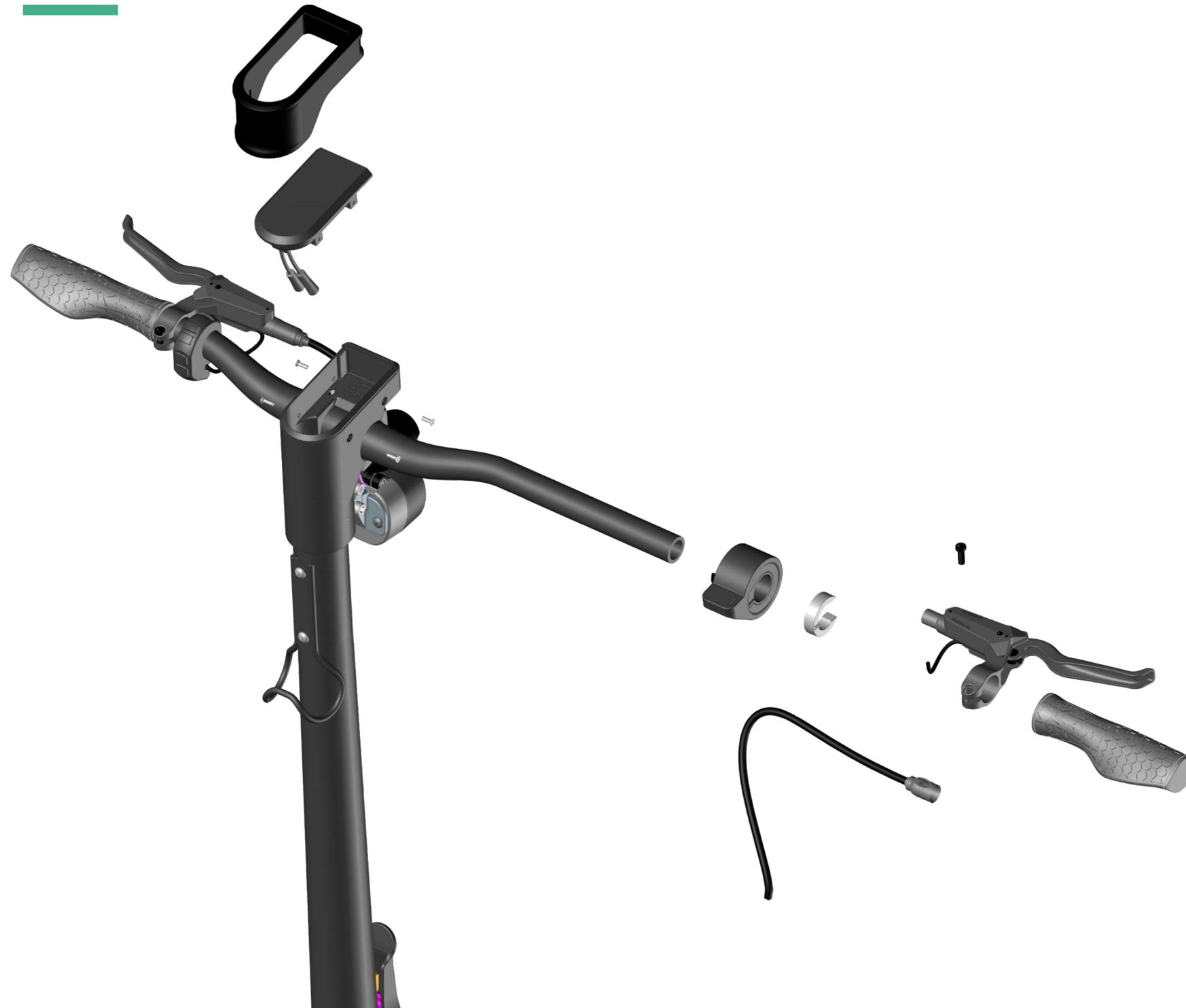
1. Löse die 4 Schrauben an den Seiten des Displays
