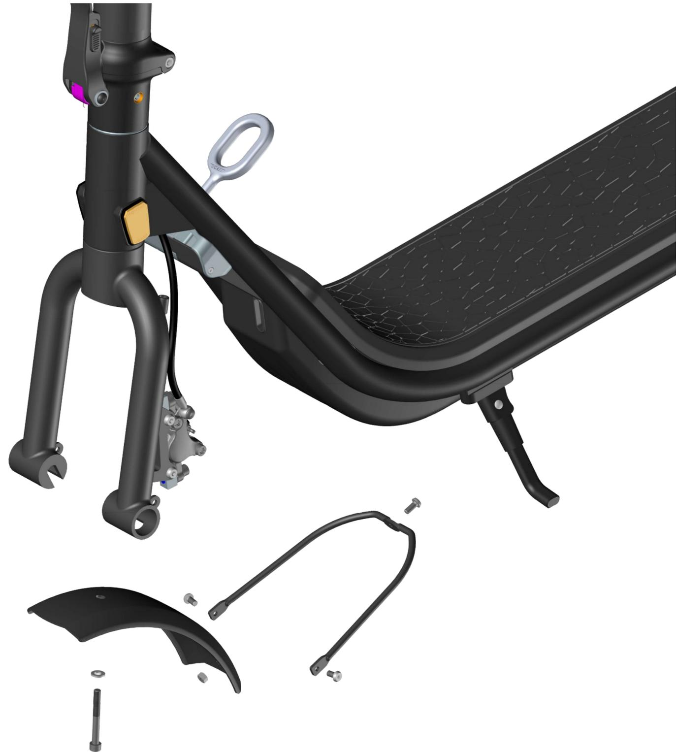
1. Demontiere das Vorderrad wie im Absatz „Radausbau & Reifentausch“ beschrieben
