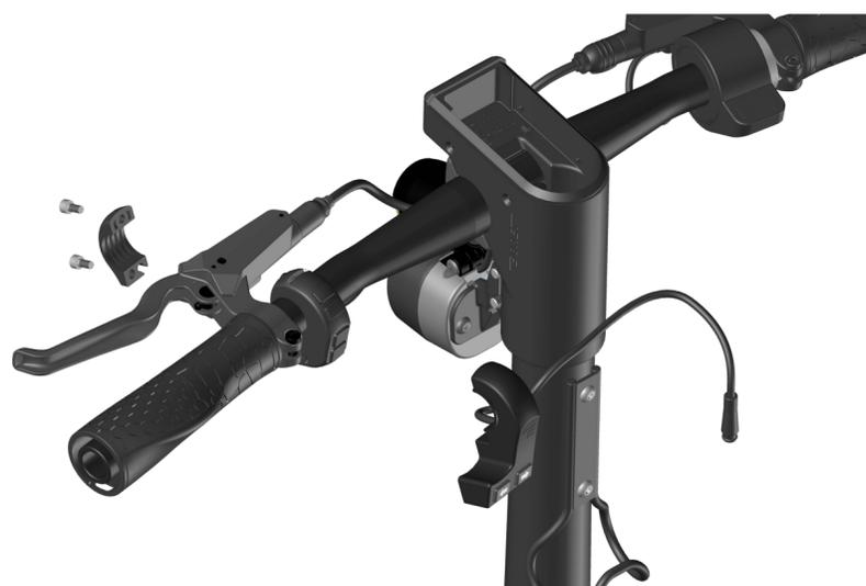
1. Entferne das Display und löse die Steckverbindungen vom Bedienfeld und den Blinkern
