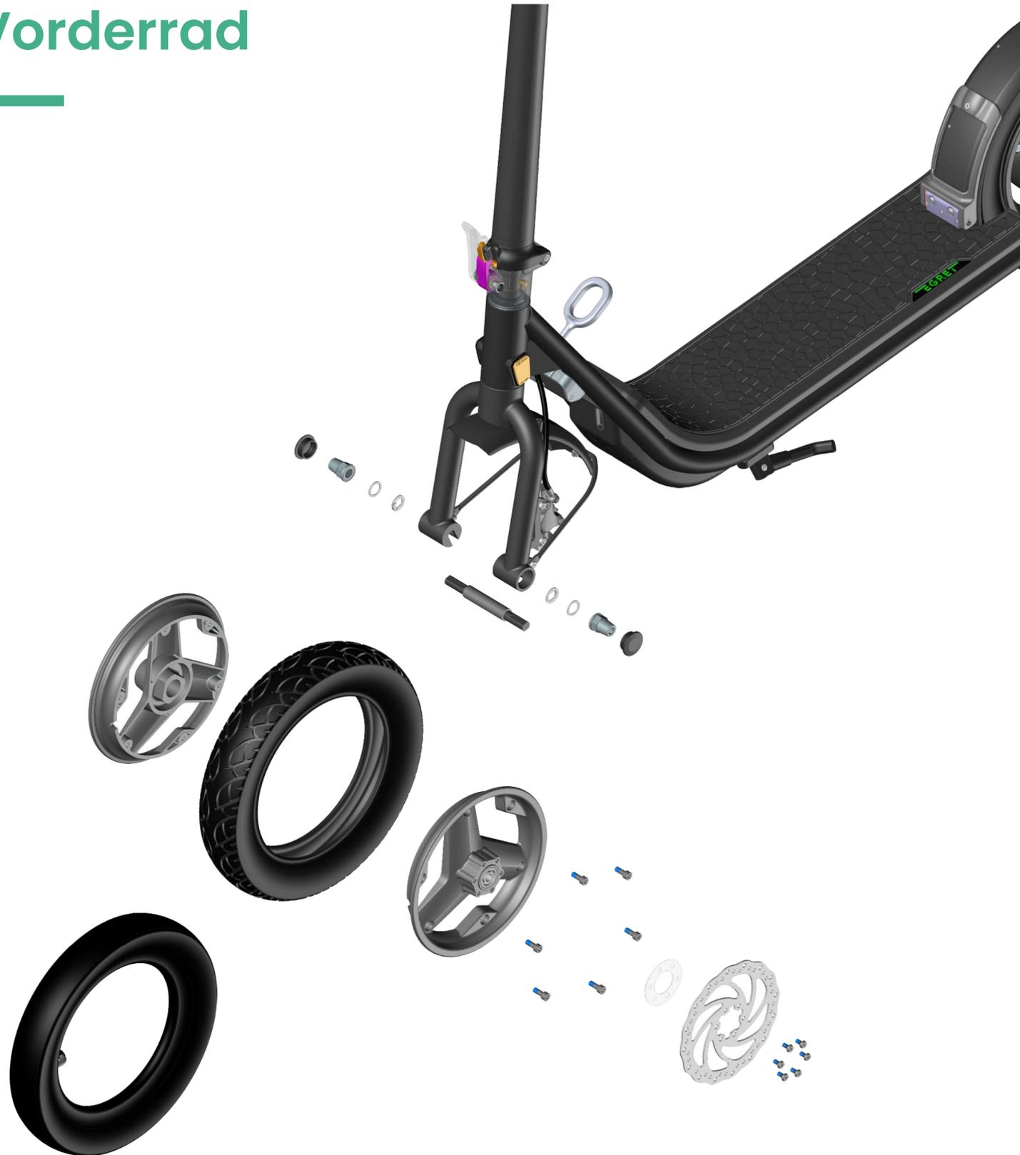
1. Löse beide Achsmuttern und die seitlichen Befestigungsschrauben der Bremse.
