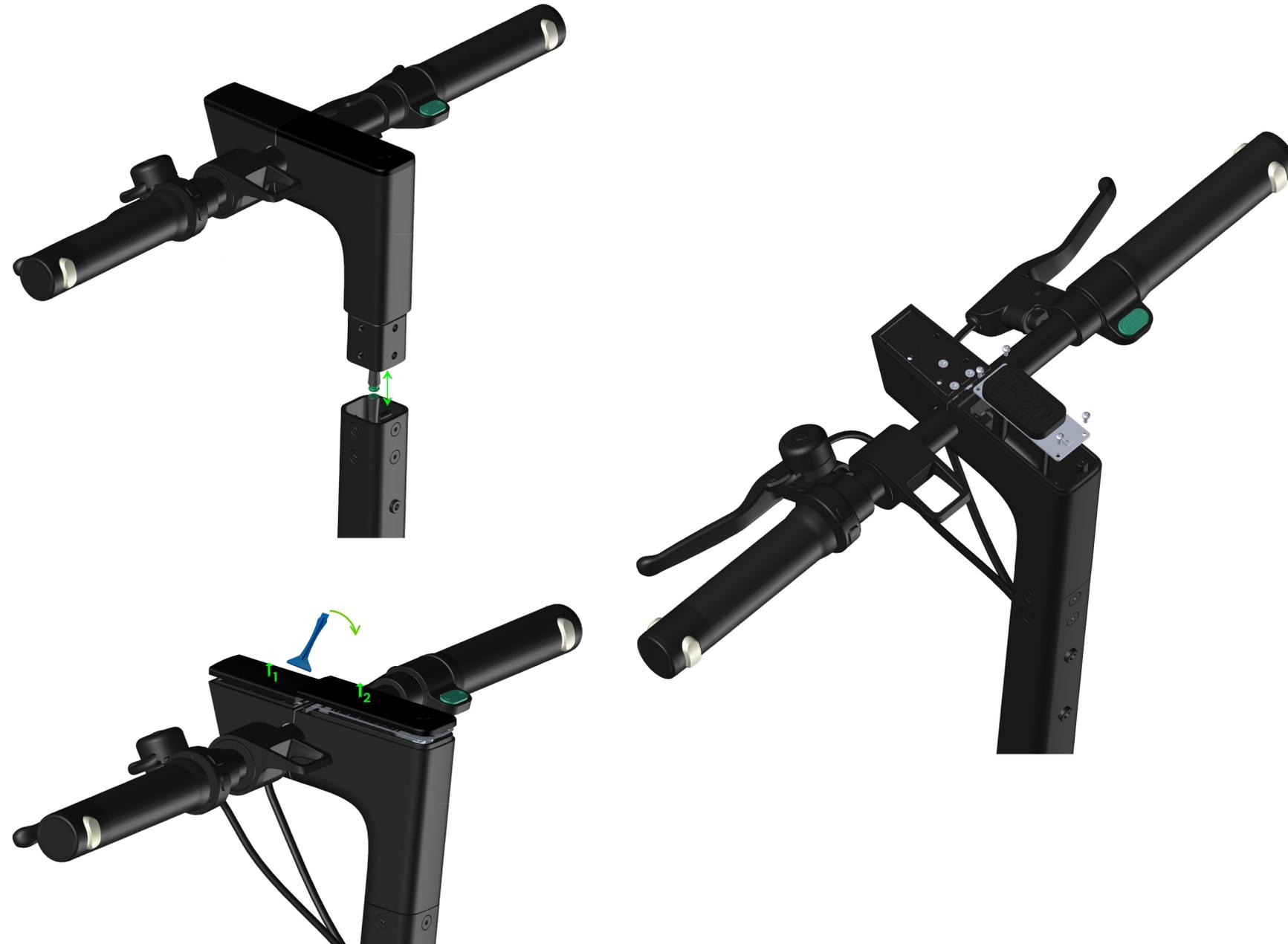
1. Demontiere den Lenker und löse die Steckverbindung im Lenkrohr
