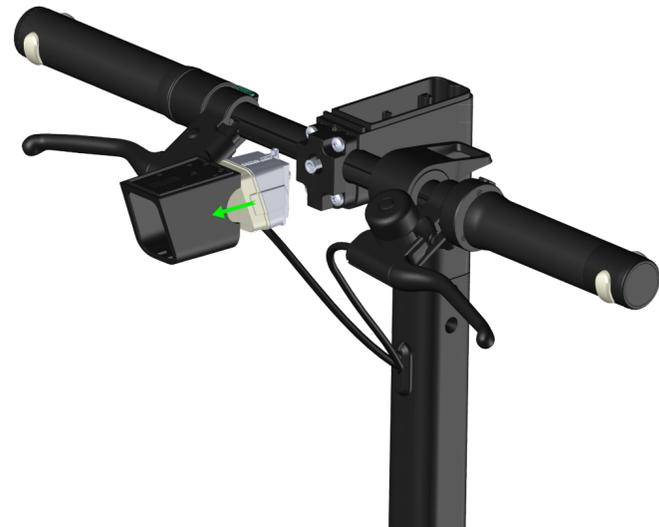
1. Demontiere den Lenker und löse die Steckverbindung im Lenkrohr
