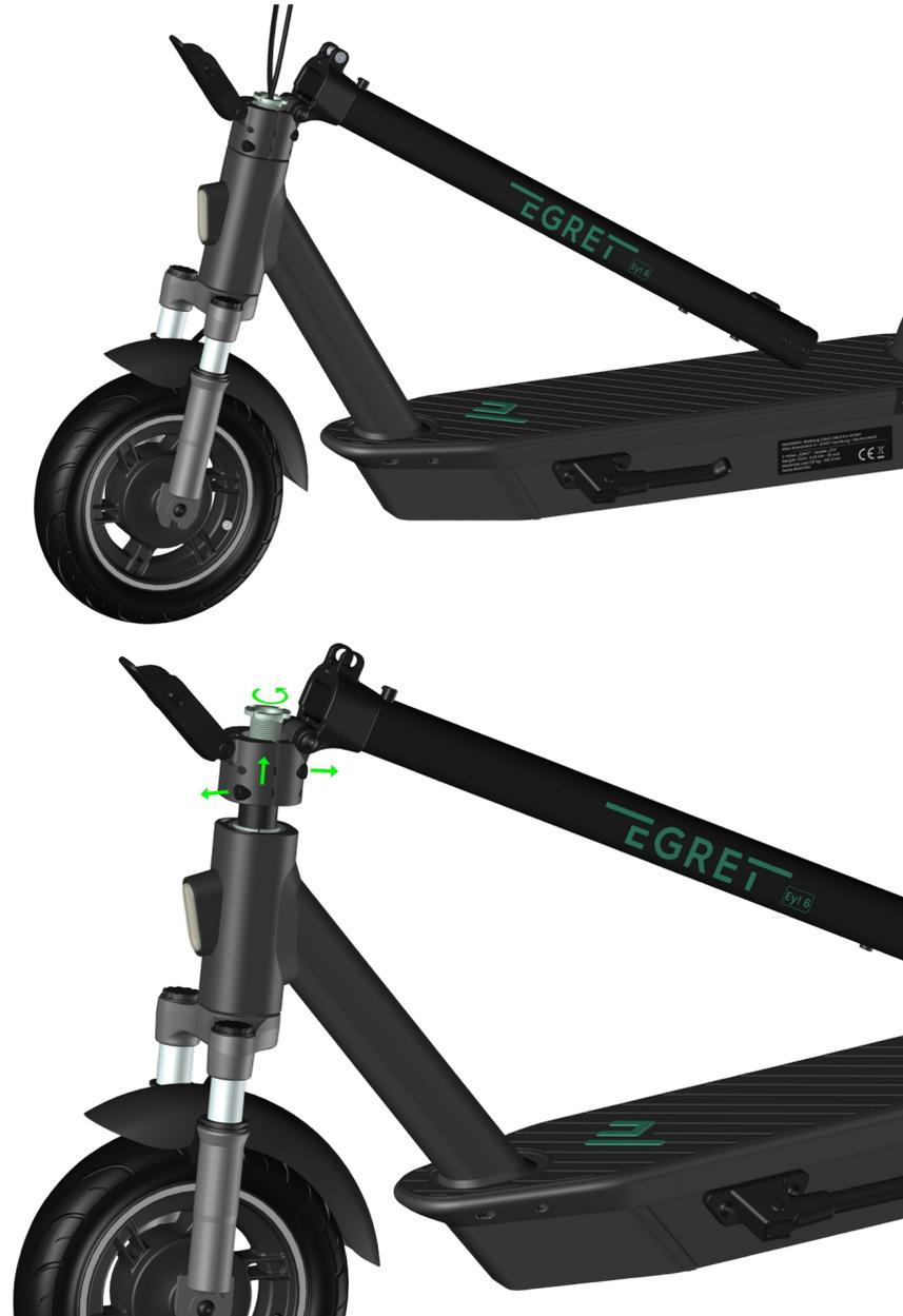
1. Löse zuerst beide Bremskabel von den Bremshebeln
