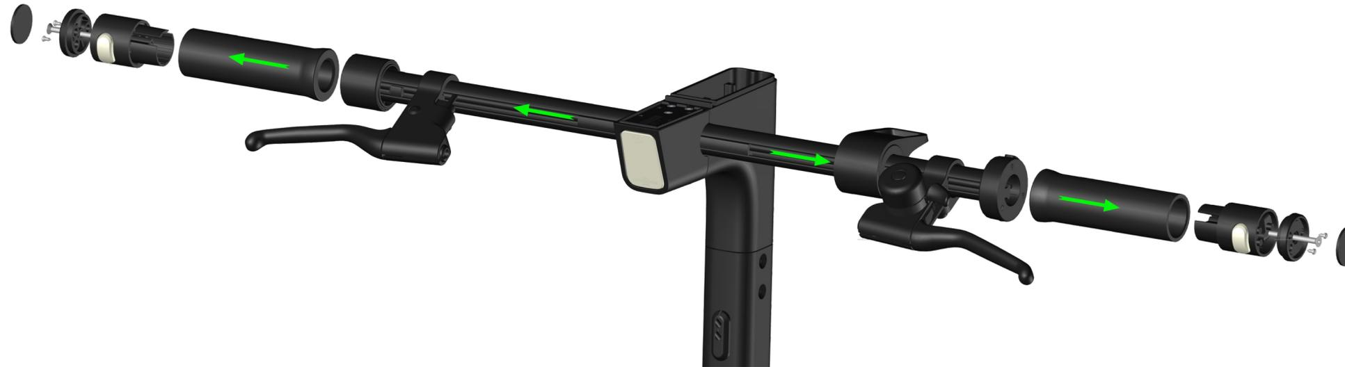
1. Demontiere den Lenker und löse die Steckverbindung im Lenkrohr
