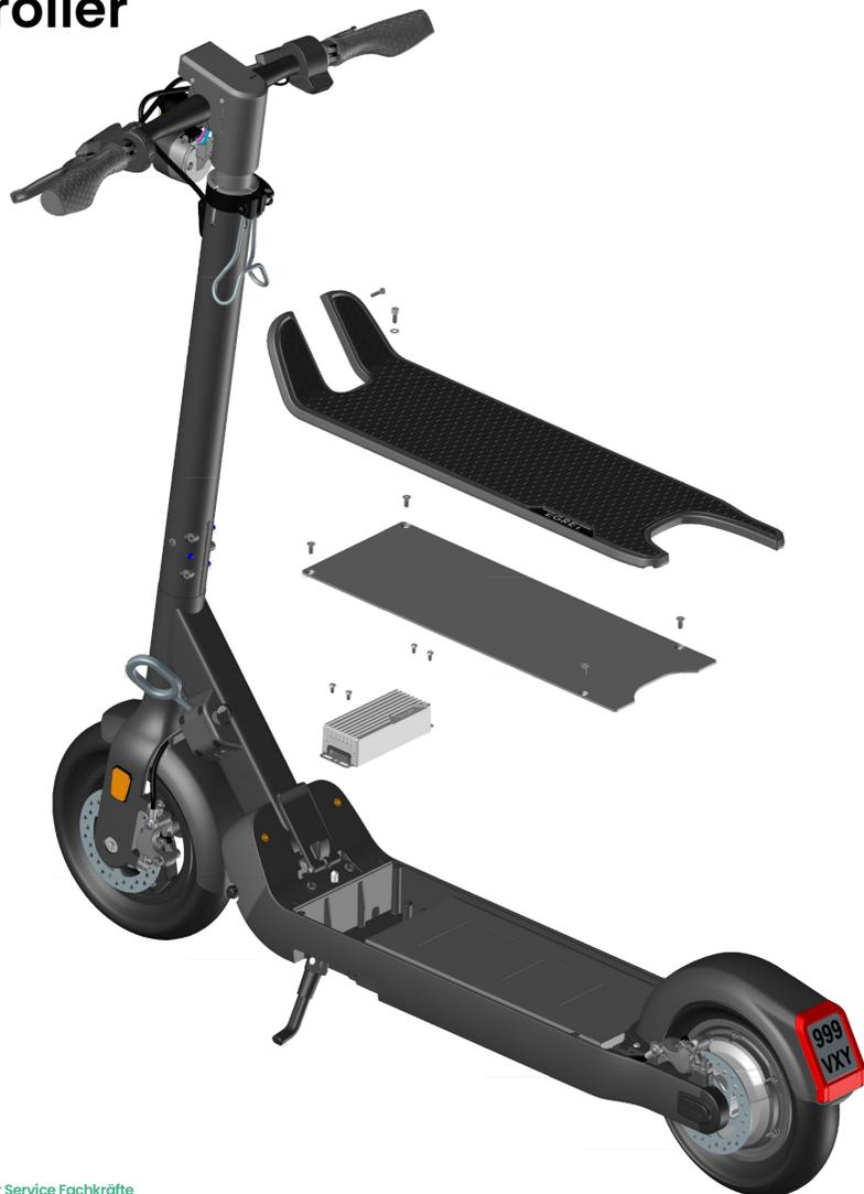
**1. Öffne die Einschnitte an der Gummimatte um an die darunter liegenden Schrauben zu kommen und löse diese**
