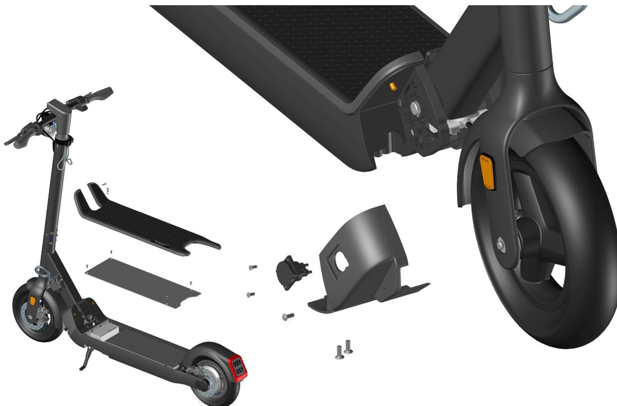
**1. Öffne die Einschnitte an der Gummimatte um an die darunter liegenden Schrauben zu kommen und löse diese**
