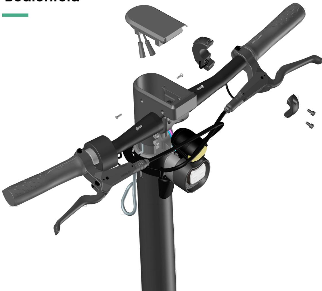
1. Löse die 4 Schrauben an den Seiten des Displays
