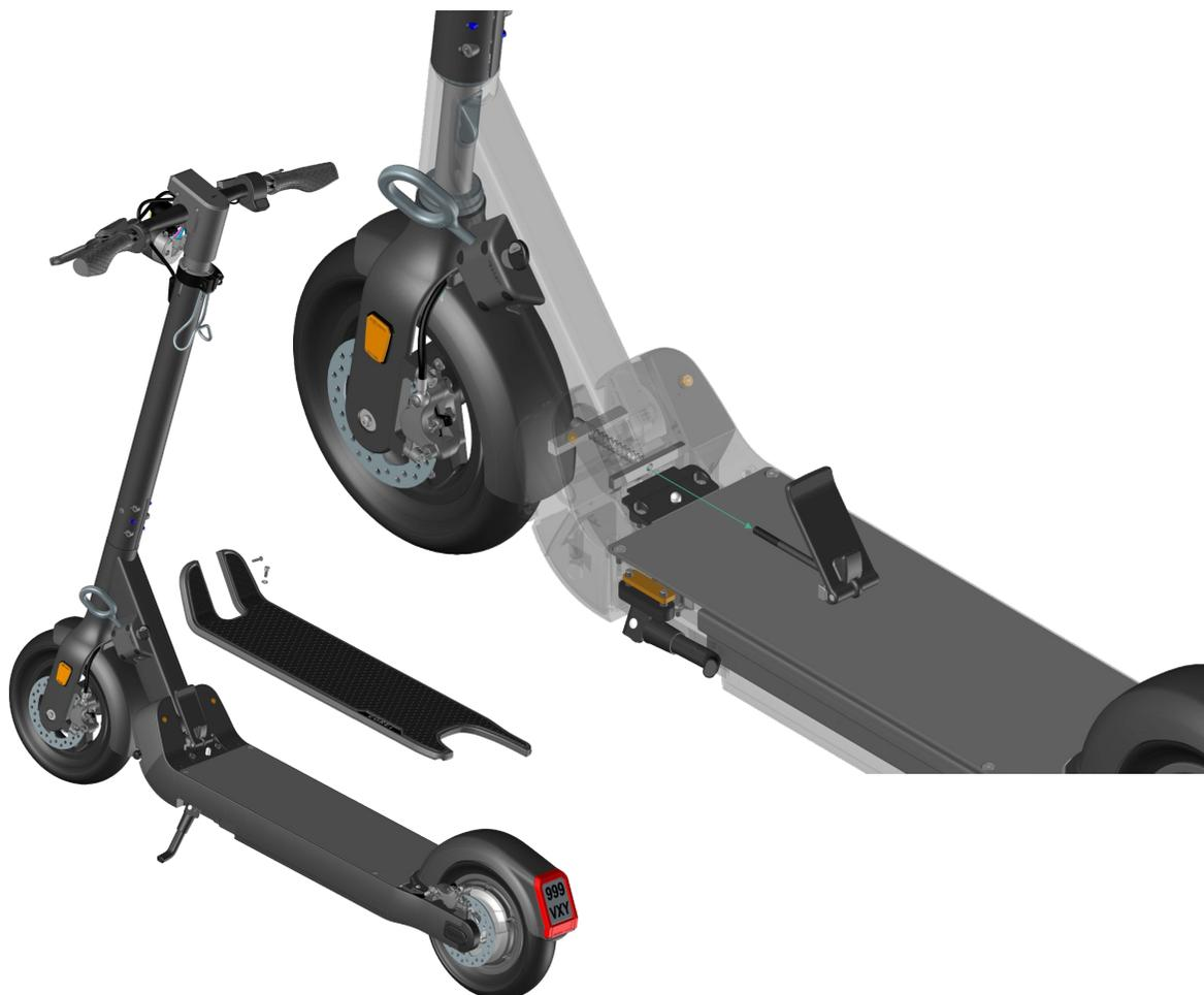
1. Öffne die Einschnitte an der Gummimatte um an die darunter liegenden Schrauben zu kommen und löse diese
