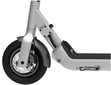
4. Fermez la serrure de sécurité (**G**) en la dévissant un peu et en la tournant à 90°. Assurez-vous qu'elle est complètement encliquetée (fermée). La trottinette se trouve maintenant à l'étape de verrouillage 3.
