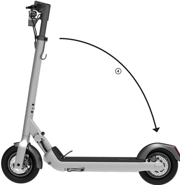
4.1 La trottinette est maintenant repliée et peut être transportée sur le tube de direction.
