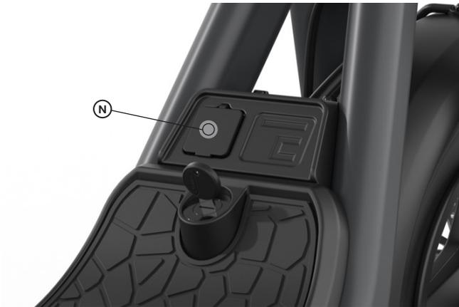
3. Verbinde das Ladekabel mit dem ausgeschalteten Egret-Elektroroller.
