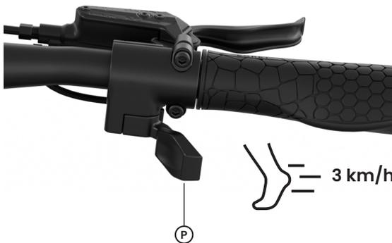
Damit der Egret losfährt, musst du ihn **über 3 km/h anschieben**. Erst oberhalb dieser Geschwindigkeit wird die Motorunterstützung eingeschaltet.
