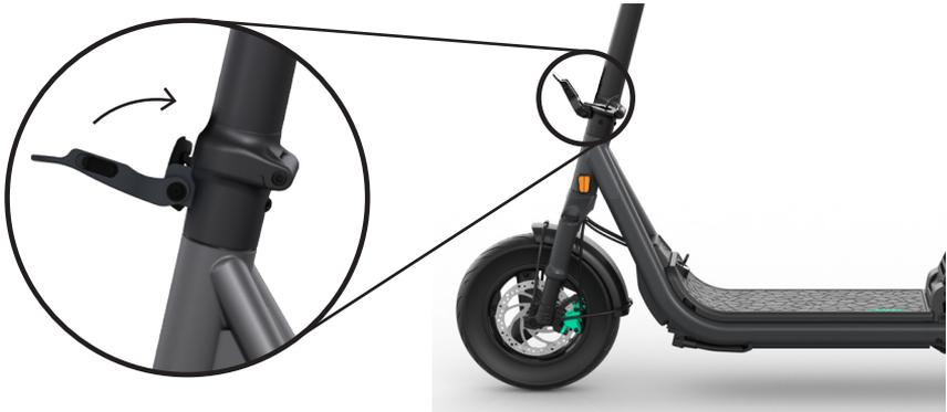
2. Drücke den Hebel (J) weiter in Richtung des Lenkrohrs, bis der Sicherungsschieber (K) hörbar einrastet. Der Elektroroller befindet sich nun in Verriegelungsschritt 2.
