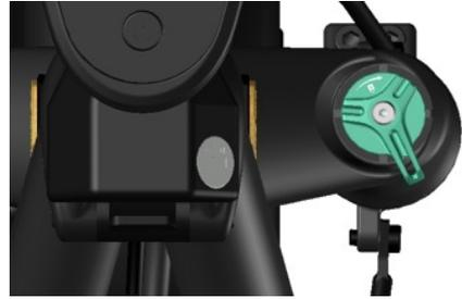
Bei der hinteren Schwinge können die Vorspannungen der beiden Federn individuell über die Stellmuttern geändert werden. Drehe diese im Uhrzeigersinn, um die Vorspannung zu erhöhen, gegen den Uhrzeigersinn, um diese zu verringern.
