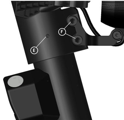
5. Die Madenschraube (E) im Lenker muss exakt über dem Loch im Lenkrohr positioniert sein. Schraube die Madenschraube so weit ein, dass diese bündig mit dem Lenker abschließt. So gewährleistest du, dass der Lenker im richtigen Winkel angebracht ist. Ziehe die zwei Schrauben (F) handfest (6 Nm) an.
