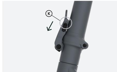
3. Stelle sicher, dass sich der Sicherungsschieber (K) in der geschlossenen Position befindet.
