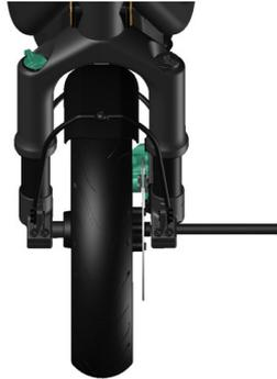
4. Sichere die Achsschraube, indem du die beiden bremsseitigen Sicherungsschrauben (D) der Gabel leicht (5-7 Nm) festziehst.
