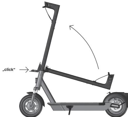
3. Drücke den Falthebel nach oben oder in Richtung des Lenkrohrs, bis der Sicherungsschieber hörbar einrastet. Der E-Scooter befindet sich nun in Verriegelungsschritt 2/2.
