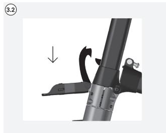
4. Falte das Lenkrohr nach unten und hänge die Lenkerverriegelung in die Transporthalterung ein, indem du den Lenkerhaken nach hinten schwenkst.
