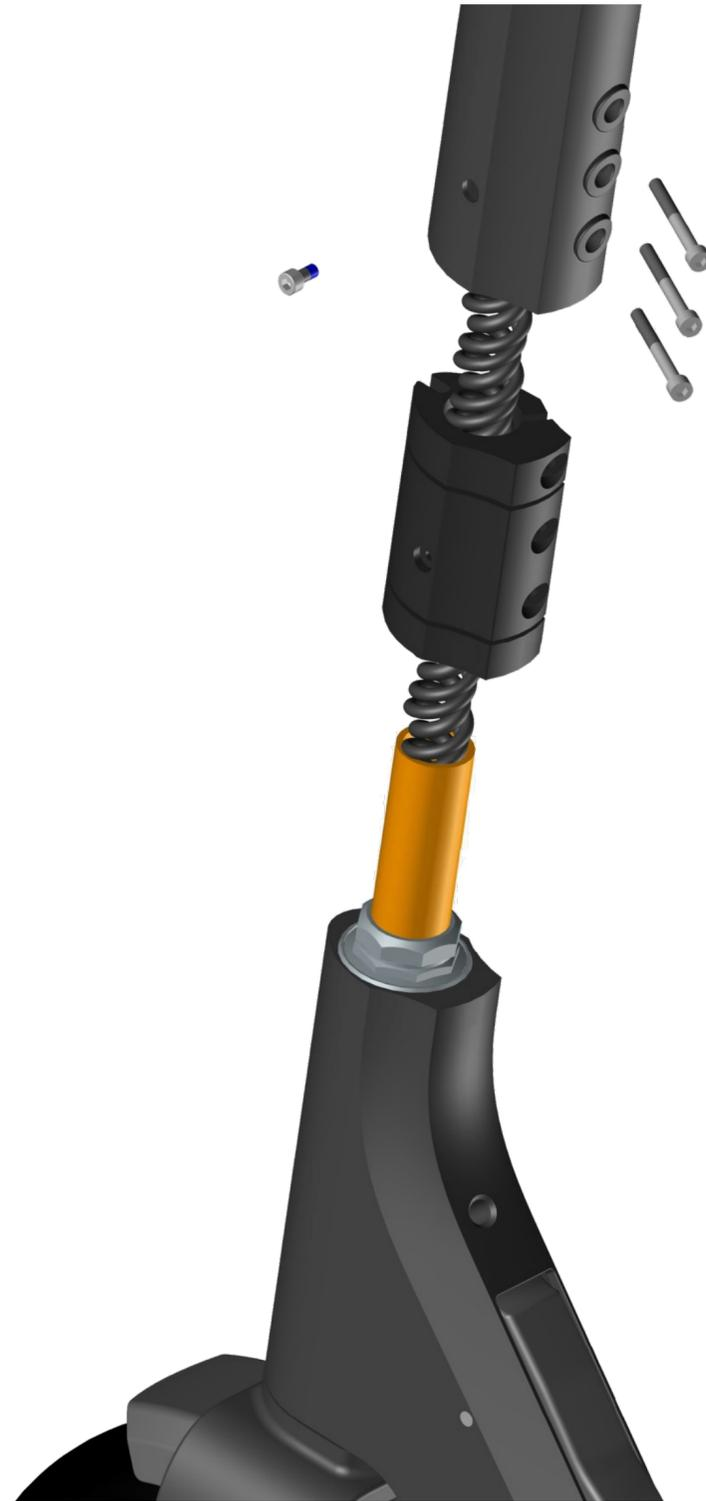
1. Löse die drei Klemmschrauben am unteren Ende des Lenkrohrs
