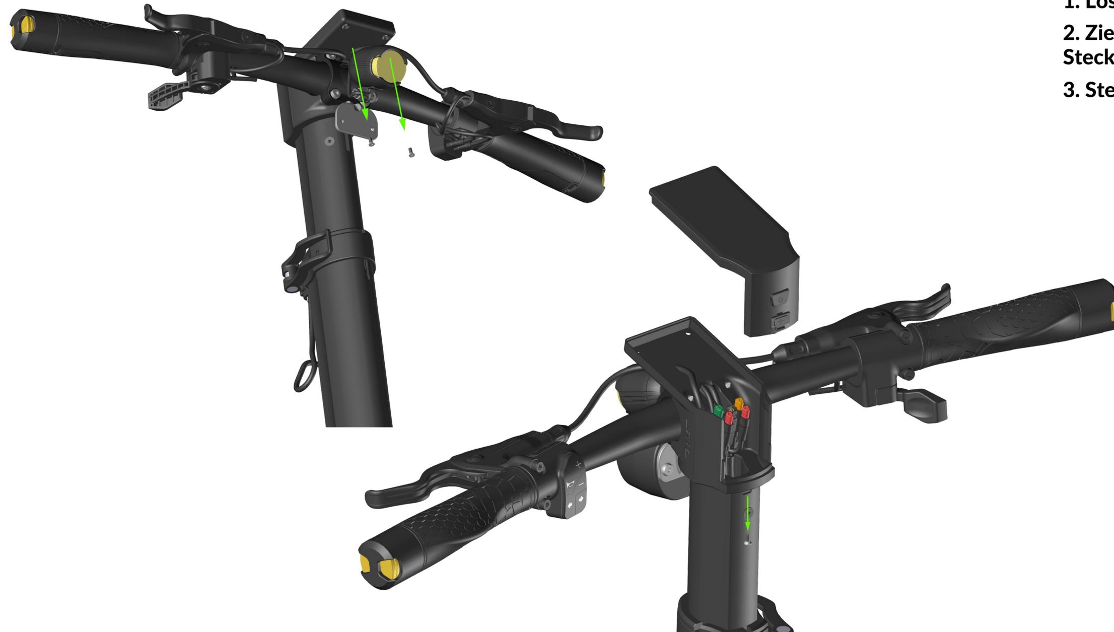
1. Löse die 4 Schrauben an den Seiten des Displays
